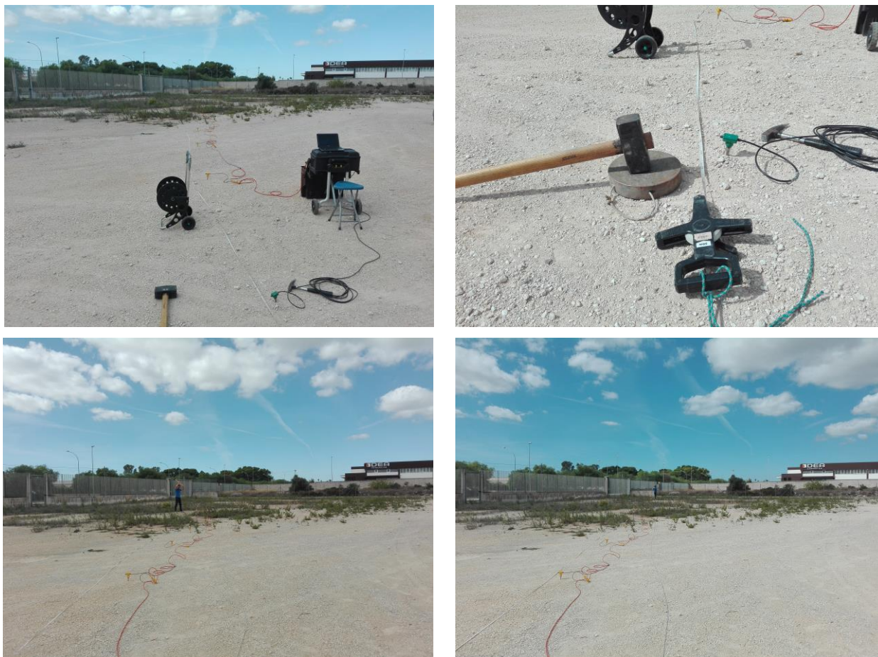
Fig. 8.4: Documentazione fotografica Indagini Sismiche Re.Mi.-MASW
